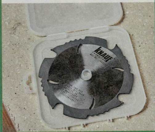
8 Damit kann die Verlegung der tragenden Systemelemente beginnen. An den ersten Platten werden wandseitig die Federn abgesägt. Mit der Handkreissäge und einer Führungsschiene geht das schnell. Staubabsaugung nicht vergessen!
